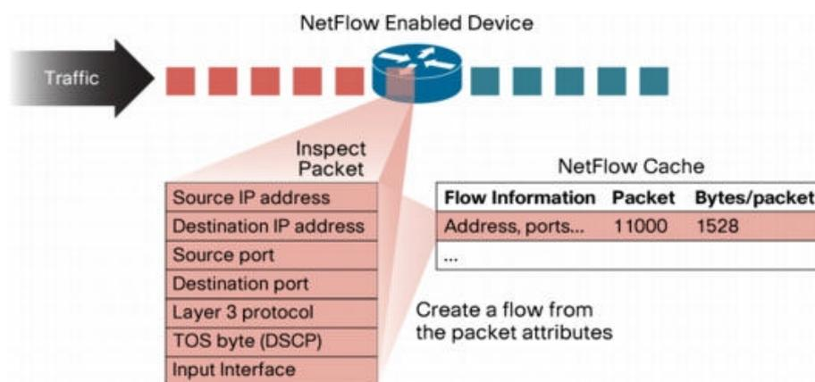
Die gesammelten Daten werden als Flows im NetFlow-Cache des Gerätes gesammelt und als UDP-Datenstrom ausschließlich an den registrierten Kollektor versendet. NetFlow ist ein passives Verfahren, d.h. ohne den Netzverkehr aktiv zu beeinflussen.
